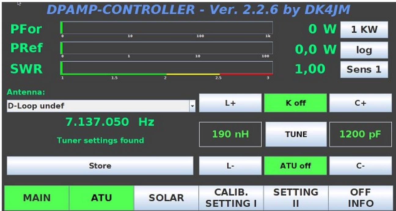
Im „**ATU**“-Menü können, wenn ein Tuner eingebaut ist und im Menü „**SETTINGS II**“ dieser „**enabled**“ wurde, die Einstellungen der „**L**“ und „**C**“-Bänke vorgenommen sowie das „**K**“ Relais (C's entweder am Eingang oder am Ausgang der PA) und der Tuner selbst mit dem Button „**ATU on / off**“ ein- bzw. ausgeschaltet werden.
